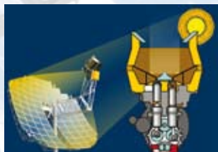
Общая схема солнечного концентратора и, отдельно, разрез стирлинга, установленного в фокусе зеркала.
